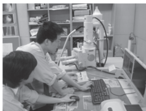
SEM及びX線元素分析装置による分析
